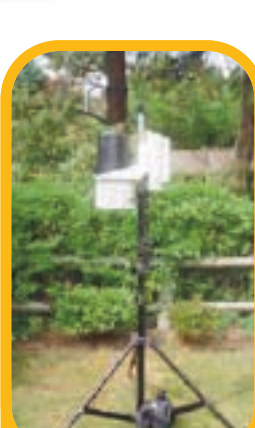
Station météorologique portable (mesure la vitesse et la direction du vent, la température et la pluviométrie)
