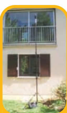
Microphone (ici placé à une hauteur d'environ 4 m) : enregistre les fluctuations des niveaux de bruit
