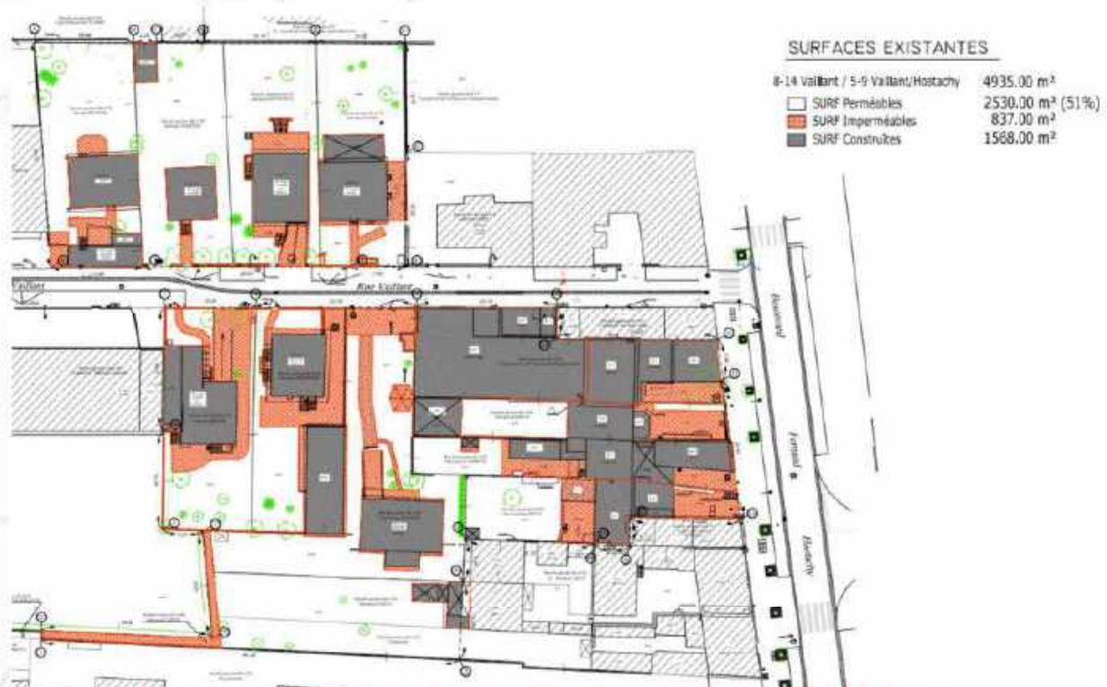
**Figure 24: Détails des surfaces perméables ou non sur le site d'étude**
