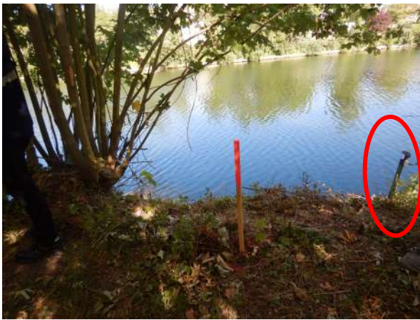
Piquetage rouge en sommet de digue le long du chemin matérialise et délimite chaque plot de 11 m de large, les autres piquets métalliques supportent les cellules nécessaires au théodolite.
